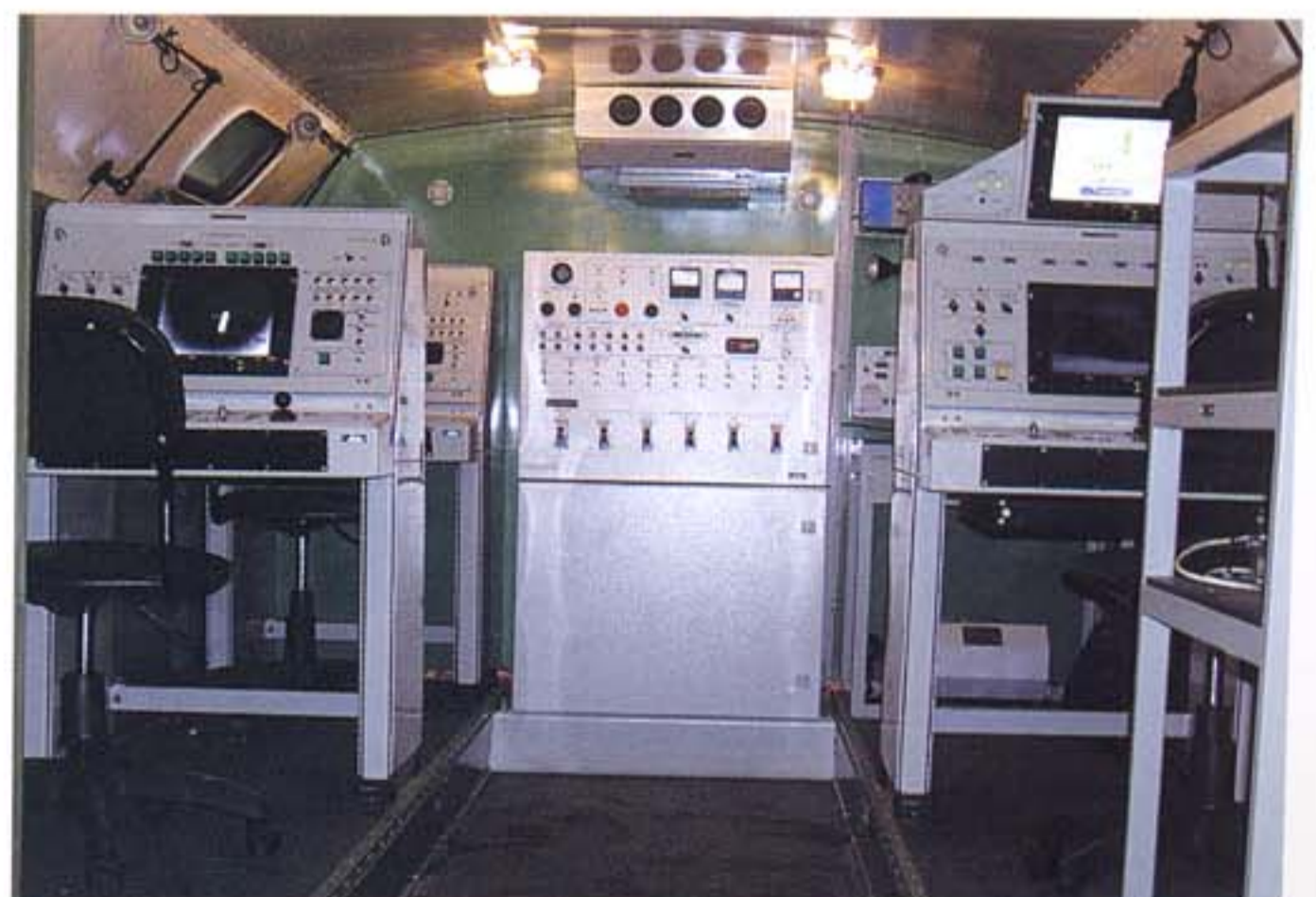
Рабочие места боевого расчёта командного поста комплекса АЗ A3 Multipurpose Missile and Gun System Combat Crew's Automated Workstations
